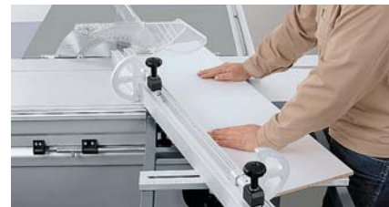
Mitre cut using crosscut-mitre fence.
